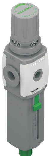
Przykład : T171BEBC : rozmiar 1, Filtroreduktor z gwintami z technopolimeru, przyłącza G1/4\", wkład 20 µm, zakres regulacji od 0 do 8 bar.
