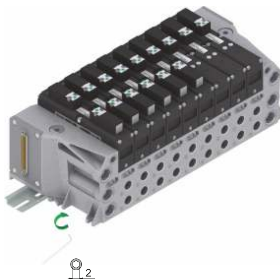
Montaż na szynie DIN
