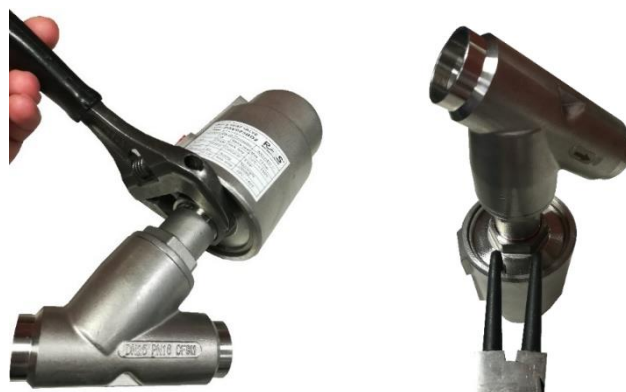
Rys. 4 Demontaż górnej części zaworu (siłownika)
