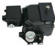
Kod opcji 7 z wewnętrznym transmitterem pozycji (4 do 20 mA) i zewnętrznym mocowaniem pod wyłącznik krańcowy
