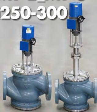
Valvole pneumatiche a due e tre vie di regolazione, DN 250 e DN 300, con corpo in ghisa sferoidale (EN-GJS-400-18LT), corpo AISI316 (1.4408), acciaio al carbonio LCB A352 (1.6220), superduplex F55, azionate da servocomando a membrana tipo: N109(Ø520), N216(Ø520 doppio). Le tre vie possono essere eseguite sia deviatrici che miscelatrici. Per ulteriori informazioni consultare il catalogo 11M9-2\_11M9-3 DN250-300.
