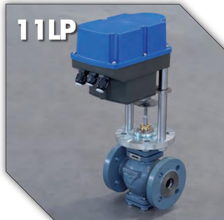
Attuatore elettrico tipo "LP" a movimento lineare, alimentazione 24VAC/DC...230VAC; segnale di input 3-punti o modulante, grado di protezione IP65. Funzione fail-safe. Custodia in alluminio-polycarbonato. Per ulteriori informazioni rivolgersi al nostro ufficio tecnico/commerciale.
