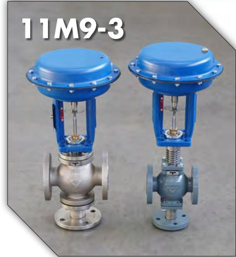
Valvole pneumatiche a tre vie di regolazione, disponibili dal DN 15 al DN 200, con corpo in ghisa sferoidale (EN-GJS-400-18LT) o corpo AISI316 (1.4408), acciaio al carbonio LCB A352 (1.6220), superduplex F55, azionate da servocomando a membrana tipo: SS0(Ø205), SS1(Ø275), SS3(Ø360), SS2(Ø430), SS2L(Ø430 lungo), SS4(Ø430 doppio). Sono disponibili nelle versioni a tre vie deviatrici o a tre vie miscelatrici. Per ulteriori informazioni consultare il catalogo 11M9-3.
