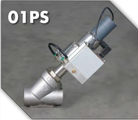
Le valvole pneumatiche proporzionali con controllo di posizione da trasduttore lineare a due vie a flusso libero (45°), sono disponibili dal DN15 al DN65 con attacchi filettati BSPP femmina, a saldare di tasca, filettati NPT, flangiati foratura PN25 UNI EN 1092-1 (spessore ridotto). Corpo in AISI 316 (1.4408) e servocomando in AISI 304 (1.4301), temperatura massima d'esercizio +195°C. Per ulteriori informazioni consultare il catalogo 01 PS.
