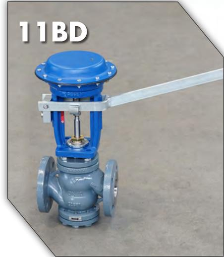
**Valvola di scarico ad azionamento pneumatico e manuale o solo manuale, disponibile dal DN 15 al DN 65, con corpo in ghisa sferoidale EN-GJS-400-18LT (GGG40.3) o AISI316 (1.4408), acciaio al carbonio A216 WCB, temperature fino a +350°C. Per ulteriori informazioni consultare il catalogo 11BD.**
