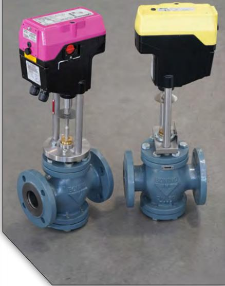
**Attuatore elettrico tipo "LS" a movimento lineare, con auto-adattamento dell'alimentazione 24VAC/DC...230VAC; segnale di input: 3 punti o modulante; custodia in alluminio IP66. Fornibile antideflagrante e ATEX. Per ulteriori informazioni consultare il catalogo 11 LS.**
