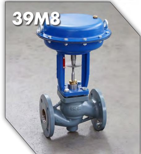
Valvole pneumatiche a due vie di regolazione serie "M8" con corpo in ghisa sferoidale EN-GJS-500-7, temperatura di utilizzo: -10°C +210°C, o in acciaio al carbonio LCB A352 (1.6220), temperatura di utilizzo: -15°C +210°C, disponibili dal DN 15 al DN 100, azionate da servocomando a membrana tipo: SS0 (Ø200), SS1 (Ø 275), SS3 (Ø360), SS2 (Ø430) SS6 (2xØ275), SS5 (2xØ360), SS4 (2XØ430).
