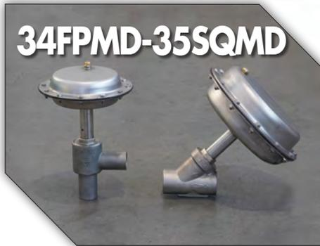
Valvole con corpo in acciaio inox AISI 316 (1.4408), aventi un servocomando modulante, disponibili dal DN 15 al DN 65 nei vari segnali di comando: 3÷15, 6÷18, 6÷30 psi. Possono operare ad una temperatura massima di +195°C e sono fornibili con una svariata serie di connessioni. Sono caratterizzate da ingombri ridotti che ne permettono l'installazione anche dove vi sono problemi di spazio.
