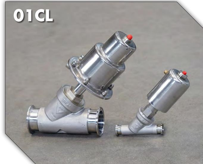
Valvole pneumatiche a due vie tipo on-off a flusso libero (45°) servocomando in acciaio inox AISI304 (1.4301) e corpo in acciaio inox AISI316 (1.4408) attacchi clamp ASME BPE
