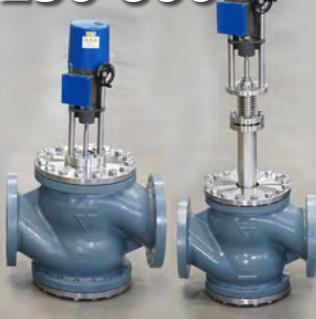
**Valvole pneumatiche a due e tre vie di regolazione, DN 250 e DN 300, con corpo in ghisa sferoidale (EN-GJS-400-18LT), corpo AISI316 (1.4408), acciaio al carbonio LCB A352 (1.6220), superduplex F55, azionate da servocomando a membrana tipo:N109(Ø520), N216(Ø520 doppio). Le tre vie possono essere eseguite sia deviatrici che miscelatrici. Per ulteriori informazioni consultare il catalogo 11M9-2\_11M9-3 DN250-300.**
