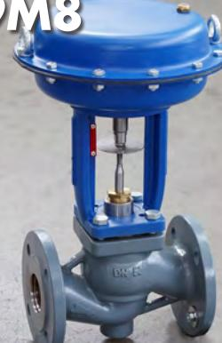
**Valvole pneumatiche a due vie di regolazione serie "M8" con corpo in ghisa sferoidale EN-GJS-500-7, temperatura di utilizzo: -10°C +210°C, o in acciaio al carbonio LCB A352 (1.6220), temperatura di utilizzo: -15°C +210°C, disponibili dal DN 15 al DN 100, azionate da servocomando a membrana tipo: SS0 (Ø200), SS1 (Ø 275), SS3 (Ø360), SS2 (Ø430) SS6 (2xØ275), SS5 (2xØ360), SS4 (2XØ430). Caratteristiche principali delle valvole modulanti serie "M8" sono funzionalità ed economicità.**
