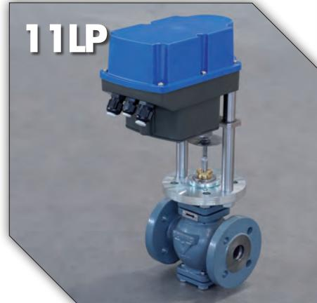
**Attuatore elettrico tipo "LP" a movimento lineare, alimentazione 24VAC/DC...230VAC; segnale di input 3-punti o modulante, grado di protezione IP65. Funzione fail-safe.**
