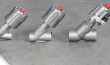
**Valvole pneumatiche a due vie di intercettazione tipo on-off a flusso libero (45°), disponibili nei funzionamenti normalmente chiuso, normalmente aperto o a doppio effetto dal DN 15 al DN 25, corpo in AISI 316 (1.4408) filettato BSPP femmina, e servocomando in AISI 304 (1.4301); ha dimensioni compatte ed opera normalmente a temperature da -15°C fino a +185°C.**
