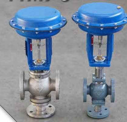
Valvole pneumatiche a tre vie di regolazione, disponibili dal DN 15 al DN 200, con corpo in ghisa sferoidale (EN-GJS-400-18LT) o corpo AISI316 (1.4408), acciaio al carbonio LCB A352 (1.6220), superduplex F55, azionate da servocomando a membrana tipo: SS0(Ø205), SS1(Ø275), SS3(Ø360), SS2(Ø430), SS2L(Ø430 lungo), SS4(Ø430 doppio). Sono disponibili nelle versioni a tre vie deviatrie o a tre vie miscelatrici. Per ulteriori informazioni consulta il catalogo 11M9-3.
