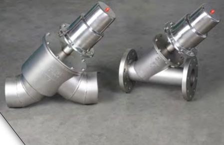
**Valvole pneumatiche a due vie di intercettazione tipo on-off a flusso libero (45°), disponibili nei funzionamenti normalmente chiuso, normalmente aperto o a doppio effetto, dal DN 80 al DN 150, con attacchi a saldare di testa, flangiati con foratura PN16 UNI EN 1092-1, flangiati ridotti. Corpo in acciaio inox AISI 316 (1.4408) e servocomando in acciaio inox AISI 304 (1.4301), temperatura massima di impiego 150°C. Per ulteriori informazioni consultare il catalogo 05FL.**
