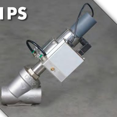
Le valvole pneumatiche proporzionali con controllo di posizione da trasduttore lineare a due vie a flusso libero (45°), sono disponibili dal DN15 al DN65 con attacchi filettati BSPP femmina, a saldare di tasca, filettati NPT, flangiati foratura PN25 UNI EN 1092-1 (spessore ridotto). Corpo in AISI 316 (1.4408) e servocomando in AISI 304 (1.4301), temperatura massima d'esercizio +195°C. Per ulteriori informazioni consultare il catalogo 01 PS.
