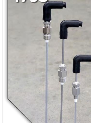
Sonde di livello conduttimetriche in acciaio inox AISI 316 (1.4401), con attacchi standard da 1/2" BSPP (filettati maschio), guaine in PTFE (temperatura massima di utilizzo 160°C).
