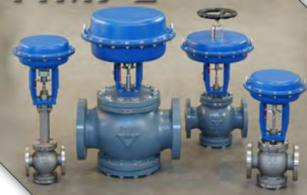
Valvole pneumatiche a due vie di regolazione, disponibili dal DN 15 al DN 200, con corpo in ghisa sferoidale (EN-GJS-400-18LT) o corpo AISI316 (1.4408), acciaio al carbonio LCB A352 (1.6220), superduplex F55, azionate da servocomando a membrana tipo: SS0(Ø205), SS1(Ø275), SS3(Ø360), SS2(Ø430), SS2L(Ø430 lungo), SS4(Ø430 doppio). Per ulteriori informazioni consultare il catalogo 11M9-2.
