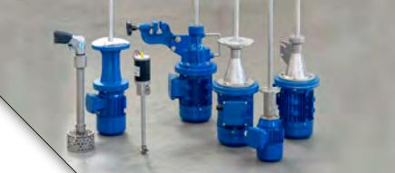
I miscelatori serie "MIX/F" con attacco a flangia, e serie "MIX/M" con attacco a morsetto, hanno motore elettrico e sono realizzati con lanterna in lega leggera. Tutte le parti a contatto con il fluido sono in acciaio inox AISI 316 (1.4401 - 1.4408). Entrambe le versioni possono essere fornite con lanterna in acciaio inox AISI 316 (1.4408) e sono previste soluzioni a disegno su richiesta.
