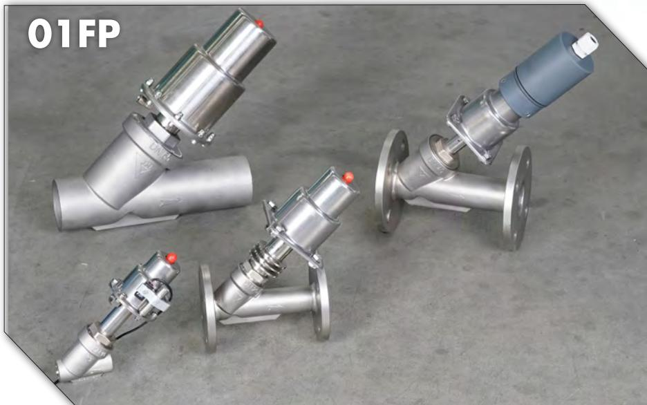
Valvole pneumatiche a due vie di intercettazione tipo on-off a flusso libero (45°), disponibili nei funzionamenti normalmente chiuso, normalmente aperto o a doppio effetto, dal DN 15 al DN 65, con servocomando in acciaio inox AISI 304 (1.4301), e temperatura di utilizzo -15°C +195°C (+210°C per /PK) oppure con prolunga alettata per temperature di utilizzo -20°C +225°C.
