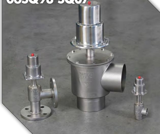
**Valvole pneumatiche di intercettazione on-off a squadra, disponibili nei funzionamenti normalmente chiuso, normalmente aperto o a doppio effetto, con servocomando in acciaio inox AISI 304 (1.4301). Serie "SQ98": con corpo in acciaio inox AISI 316 (1.4408) ottenuto per microfusione, disponibile dal DN 8 al DN 50, con connessioni filettate BSPP femmina, a saldare di tasca, flangiante con foratura PN25 UNI EN 1092-1, flangiante ridotte, e temperatura massima di utilizzo 195°C.**
