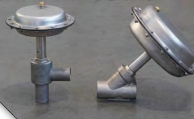
**Valvole con corpo in acciaio inox AISI 316 (1.4408), aventi un servocomando modulante, disponibili dal DN 15 al DN 65 nei vari segnali di comando: 3÷15, 6÷18, 6÷30 psi. Possono operare ad una temperatura massima di +195°C e sono fornibili con una svariata serie di connessioni. Sono caratterizzate da ingombri ridotti che ne permettono l'installazione anche dove vi sono problemi di spazio.**
