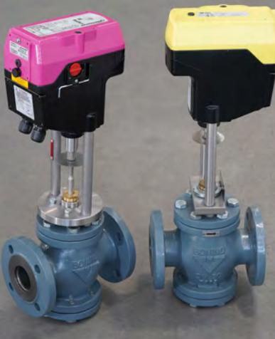
**Attuatore elettrico tipo "LS" a movimento lineare, con auto-adattamento dell'alimentazione 24VAC/DC...230VAC; segnale di input: 3 punti o modulante; custodia in alluminio IP66.**
