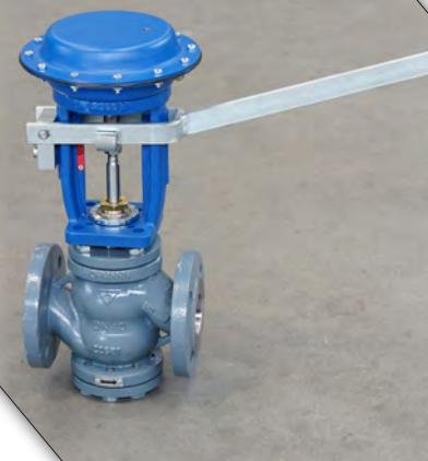
**Valvola di scarico ad azionamento pneumatico e manuale o solo manuale, disponibile dal DN 15 al DN 65, con corpo in ghisa sferoidale EN-GJS-400-18LT (GGG40.3) o AISI316 (1.4408), acciaio al carbonio A216 WCB, temperature fino a +350°C. Per ulteriori informazioni consultare il catalogo 11BD.**
